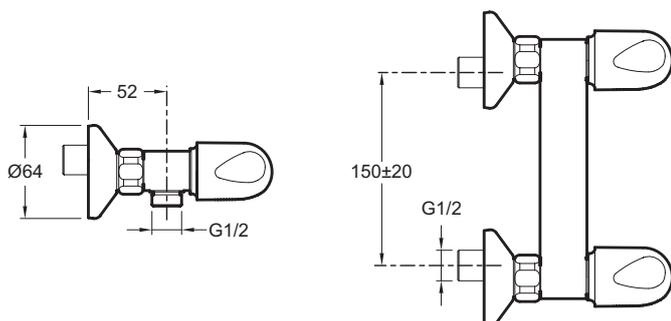
Descriptif CCTP : Mélangeur douche. E71923. Collection : GALÉO CD. POIDS : 1,1 kg. TYPE D'INSTALLATION : Mural. NORMES ET RÉGLEMENTATIONS : NF : IA - EAU : E1 A1 U3 - ACS : 15ACCLY264. TYPE : Mélangeur. DÉBIT (L/MN SOUS 3 BARS) : 14 l/mn. RACCORDS : Avec raccords et rosaces murales. MÉCANISME : Têtes à disques céramique. TYPE D'INSTALLATION : 2 trous. CLAPET ANTI-RETOUR : Oui. GARANTIE MÉCANISME : 5 ans. Clapet anti-retour sur sortie de douche.
