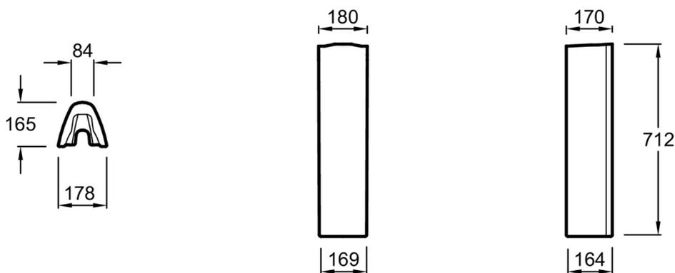
Descriptif CCTP : Colonne. E4444. Collection : BRIVE. POIDS : 8,2 kg. MATÉRIAU : Céramique. TYPE D'ACCESSOIRE : Colonne. DURÉE GARANTIE (ANNÉES) : 2.
