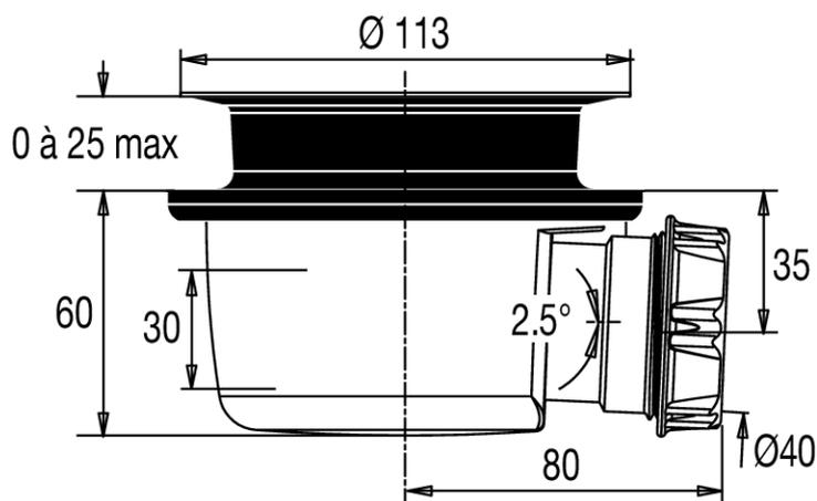
Descriptif CCTP : Bonde extra-plate NF sans capot. E78172. Collection : Hors collection. DIMENSIONS : 14 x 9 x 6 cm. POIDS : 0,3 kg. MATÉRIAU : Plastique. NORMES ET RÉGLEMENTATIONS : NF. ANTIDÉRAPANT : Non. DIAMÈTRE DE BONDE (CM) : 9. DURÉE GARANTIE (ANNÉES) : 2. Débit 29 l/min mesuré selon la norme NF. Garde d'eau de 30 mm pour éviter les remontées d'odeurs. Bonde standard diamètre 90 mm compatible avec tous les receveurs livrés avec capot et notamment Singulier et Flight Neus.
