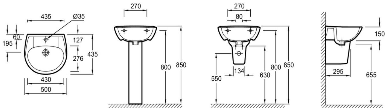
Descriptif CCTP : Lavabo 50 cm. E1345F. Collection : BRIVE. DIMENSIONS : 50 x 43,50 cm. POIDS : 12,5 kg. MATÉRIAU : Céramique. TYPE D'INSTALLATION : Autoportant. CONFIGURATION : Standard. FIXATIONS : 3 types de fixations possibles : Goujons, consoles ou crochets. PERCEMENT ROBINETTERIE : 1 trou. TROP-PLEIN : Avec trou de trop-plein. DURÉE GARANTIE (ANNÉES) : 10. INFORMATIONS COMPLÉMENTAIRES : Bonde et robinetterie non incluses. OPTIONS : Colonne, cache-siphon.
