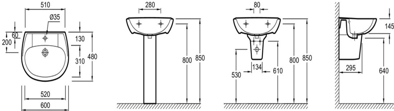
Descriptif CCTP : Lavabo 60 cm. E1286. Collection : BRIVE. DIMENSIONS : 60 x 48 cm. POIDS : 14,2 kg. MATÉRIAU : Céramique. TYPE D'INSTALLATION : Autoportant. NORMES ET RÉGLEMENTATIONS : NF ; FDES. FIXATIONS : 3 types de fixations possibles : Goujons, consoles ou crochets. PERCEMENT ROBINETTERIE : 1 trou. TROP-PLEIN : Avec trou de trop plein. DURÉE GARANTIE (ANNÉES) : 10. INFORMATIONS COMPLÉMENTAIRES : Bonde et robinetterie non incluses. OPTIONS : Colonne, cache-siphon.
