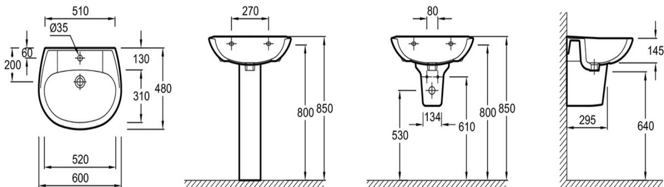
Descriptif CCTP : Lavabo 60 cm, sans trou de trop-plein. E1288. Collection : BRIVE. DIMENSIONS : 60 x 48 cm. POIDS : 13,9 kg. MATÉRIAU : Céramique. TYPE D'INSTALLATION : Autoportant. CONFIGURATION : Standard. FIXATIONS : 3 types de fixations possibles : Goujons, consoles ou crochets. PERCEMENT ROBINETTERIE : 1 trou. TROP-PLEIN : Sans trou de trop plein. DURÉE GARANTIE (ANNÉES) : 10. INFORMATIONS COMPLÉMENTAIRES : Bonde et robinetterie non incluses.
