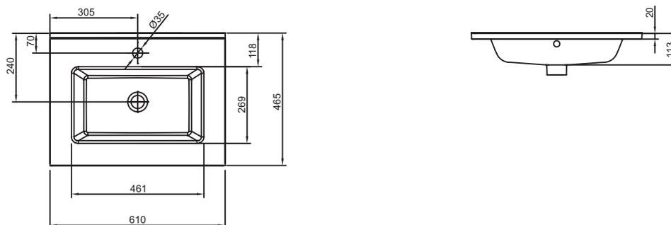
Descriptif CCTP : Plan vasque 61 cm. EXSA112. Collection : OLA. DIMENSIONS : 61 x 46,50 cm. POIDS : 11,8 kg. MATÉRIAU : Céramique. TYPE D'INSTALLATION : Posé. PERCEMENT ROBINETTERIE : Percé 1 trou. NOMBRE DE VASQUES : Simple vasque. INFOS COMPLÉMENTAIRES : robinetterie non incluse. Doit être utilisé impérativement avec le meuble associé. Plan-vasque non autoportant.
