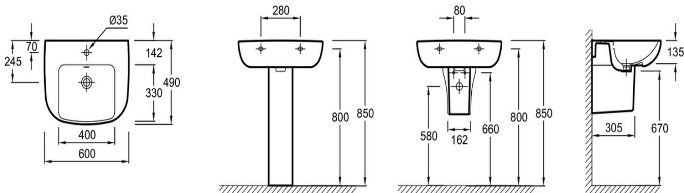
Descriptif CCTP : Lavabo 60 cm. E4736. Collection : ODÉON UP. DIMENSIONS : 60 x 49 cm. POIDS : 18,2 kg. MATÉRIAU : Céramique. TYPE D'INSTALLATION : Autoportant. NORMES ET RÉGLEMENTATIONS : NF ; FDES. CONFIGURATION : Standard. PERCEMENT ROBINETTERIE : 1 trou. TROP-PLEIN : Avec trou de trop plein. NOMBRE DE VASQUES : 1 cuve. ROBINETTERIE CONSEILLÉE : Aleo. DURÉE GARANTIE (ANNÉES) : 10. INFORMATIONS COMPLÉMENTAIRES : Bonde et robinetterie non incluses.
