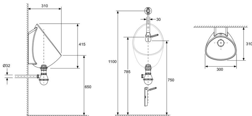
Descriptif CCTP : Pack urinoir. E0399. Collection : COQUILLE. DIMENSIONS : 31 x 41,50 cm. POIDS : 8,3 kg. MATÉRIAU : Céramique. TYPE D'INSTALLATION : Mural. NORMES ET RÉGLEMENTATIONS : NF. ALIMENTATION : Par-dessus. GARANTIE DE LA CÉRAMIQUE : 10 ans. Tube d'alimentation. Effet d'eau chromé. Bonde et siphon polypropylène. Robinet temporisé G1/2 avec réglage de débit. Deux fixations.
