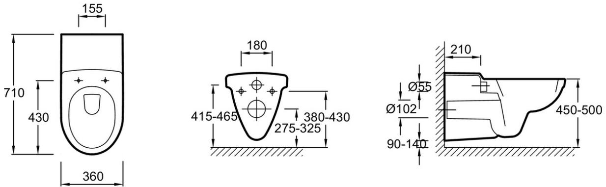
Descriptif CCTP : Cuvette suspendue PMR. E1195. Collection : ODÉON. DIMENSIONS : 71 x 36 cm. POIDS : 22,6 kg. MATÉRIAU : Céramique. TYPE D'INSTALLATION : Suspendu. LONGUEUR/PROFONDEUR : 71 cm, conforme aux recommandations PMR. FORME : Arrondie. MÉCANISME DE CHASSE : Double chasse. CONSOMMATION D'EAU : Standard 3/6 L. TYPE DE BRIDE : Ouverte (traditionnelle). GARANTIE DE LA CÉRAMIQUE : 10 ans. CONDITIONNEMENT : 1 colis. Existe en version sans trou d'abattant.
