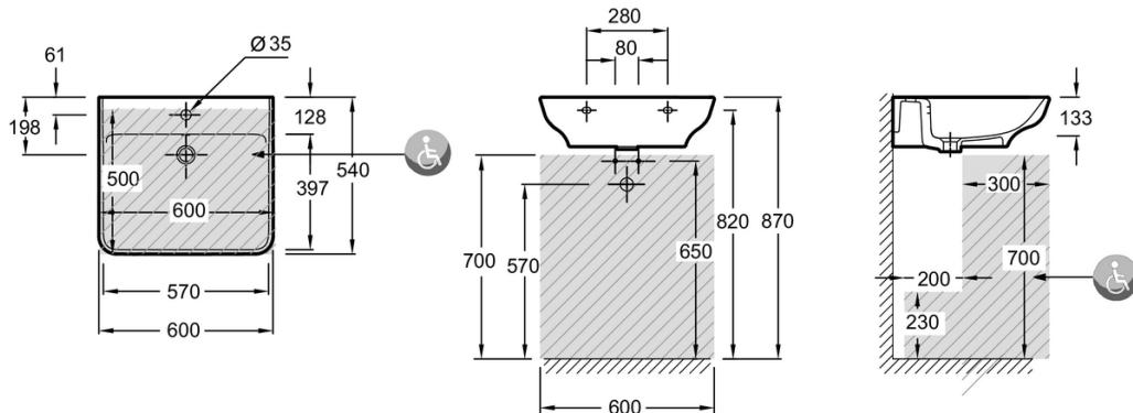
Descriptif CCTP : Lavabo PMR 60 cm, non meulé. EGG111. Collection : STRUKTURA. DIMENSIONS : 60 x 54 cm. POIDS : 19,6 kg. MATÉRIAU : Céramique. TYPE D'INSTALLATION : Autoportant. CONFIGURATION : Standard. PERCEMENT ROBINETTERIE : 1 trou. MEULÉ/NON-MEULÉ : Non meulé. TROP-PLEIN : Avec trou de trop-plein. NOMBRE DE VASQUES : 1 cuve. DURÉE GARANTIE (ANNÉES) : 10. INFORMATIONS COMPLÉMENTAIRES : Bonde et robinetterie non incluses.
