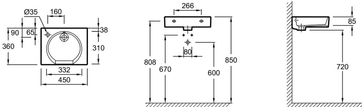
Descriptif CCTP : Lave-mains 45 cm. EGN112. Collection : ODÉON RIVE GAUCHE. DIMENSIONS : 45 x 36 cm. POIDS : 10,4 kg. MATÉRIAU : Céramique. TYPE D'INSTALLATION : Autoportant ou peut être monté sur un meuble spécifique. NORMES ET RÉGLEMENTATIONS : NF. CONFIGURATION : Standard. PERCEMENT ROBINETTERIE : 1 trou. TROP-PLEIN : Avec trou de trop-plein. ROBINETTERIE CONSEILLÉE : Odéon Rive Gauche. DURÉE GARANTIE (ANNÉES) : 10. INFORMATIONS COMPLÉMENTAIRES : Bonde et robinetterie non incluses.
