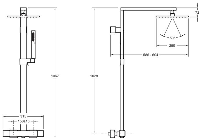
Descriptif CCTP : Colonne de douche thermostatique. E98321. Collection : STRAYT. DIMENSIONS : 145 x 39,50 x 11 cm. POIDS : 10 kg. TYPE D'INSTALLATION : Mural. NORMES ET RÉGLEMENTATIONS : ACS. AVEC OU SANS ROBINETTERIE : AVEC ROBINETTERIE. MITIGEUR : THERMOSTATIQUE. TYPOLOGIE DE ROBINETTERIE DE DOUCHE : THERMOSTATIQUE.
