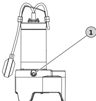
Fig. 3: Vidange d'huile de la chambre d'étanchéité
