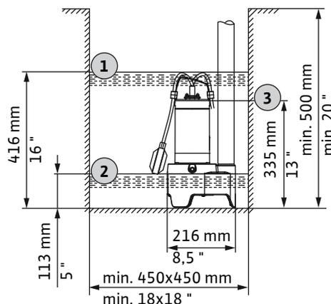
Fig. 2: Dimensions de montage et points de commutation
