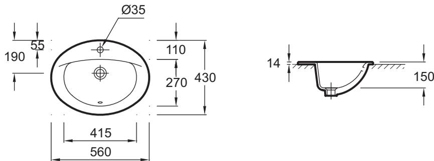
Descriptif CCTP : Vasque à encastrer par-dessus 56 cm. E4155. Collection : PATIO. DIMENSIONS : 56 x 43 cm. POIDS : 7,8 kg. MATÉRIAU : Céramique. TYPE D'INSTALLATION : Encastré par-dessus. NORMES ET RÉGLEMENTATIONS : NF. PERCEMENT ROBINETTERIE : Percé 1 trou. TROP-PLEIN : Avec trou de trop plein. PRODUIT INCLUS : (robinetterie non incluse). INFOS COMPLÉMENTAIRES : (robinetterie non incluse).
