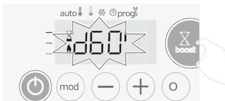
Durant la 1ère minute, vous avez la possibilité de modifier la durée du Boost de 0 à la durée maximale autorisée du Boost telle que définie lors des réglages Utilisateur (voir page 12 pour plus de détails) par intervalle de 5 minutes (ou plus rapidement par appui supérieur à 2 secondes) par appui sur (+) et (-). Cette modification sera sauvegardée et effective pour les prochains Boost.
