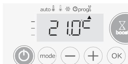
Augmentez de 2°C la température mesurée par la sonde à l'aide de la touche (+). Dans notre exemple, la température mesurée par la sonde passe de 21°C à 23°C.
