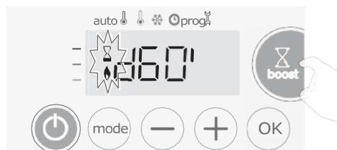
L'appareil ne chauffe plus la pièce mais le mode Boost est toujours actif : le décompte est toujours affiché, le symbole boost et le témoin de chauffe clignotent. Lorsque la température descendra au-dessous de la température maximum autorisée, le Boost sera réactivé jusqu'à la fin du décompte.
