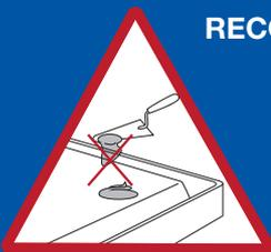
Le contact direct de plâtre ou de colle avec la sous-face du bac est à proscrire. Il ne doit pas y avoir de blocage vertical ni latéral du bac.
