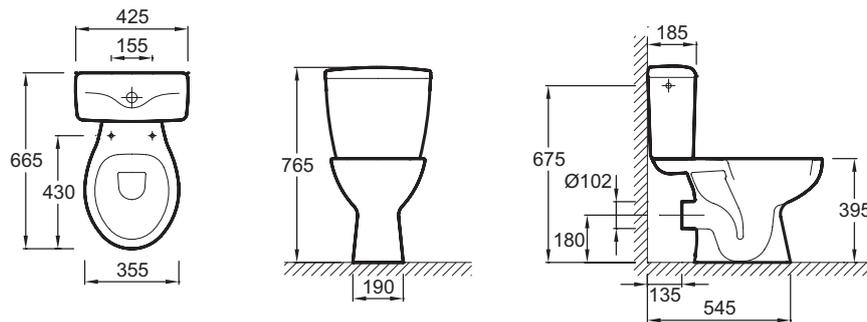
Descriptif CCTP : Pack WC, sortie horizontale. E0403. Collection : EOLIA. DIMENSIONS : 66,50 x 35,50 cm. POIDS : 36 kg. MATÉRIAU : Céramique. TYPE D'INSTALLATION : Au sol. NORMES ET RÉGLEMENTATIONS : NF. CONSOMMATION D'EAU : Standard 3/6 L.
