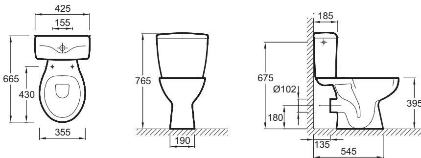
Descriptif CCTP : Pack WC, sortie horizontale. E25850. Collection : EOLIA. DIMENSIONS : 66,50 x 35,50 cm. POIDS : 36 kg. MATÉRIAU : Céramique. TYPE D'INSTALLATION : Au sol. CONSOMMATION D'EAU : Standard 3/6 L. HAUTEUR : Standard. TYPE DE BRIDE : Ouverte (traditionnelle). ALIMENTATION : Latérale. TYPE D'ABATTANT : à descente progressive. MATÉRIAU DE L'ABATTANT : Polypropylène. GARANTIE DE LA CÉRAMIQUE : 10 ans. GARANTIE DE L'ABATTANT : 2 ans.
