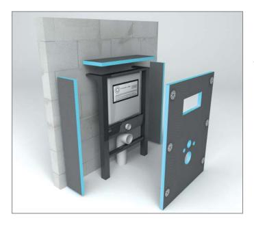
wedi I-Board (1 200 x 1 245 x 20 mm) est un élément de montage préparé et destiné à l'habillage des WC suspendus. Facilement adaptable aux besoins de chacun grâce à une largeur de 1 200 mm. Solidité et résistance extrêmes en dépit d'un poids faible (résiste jusqu'à 400 kg à partir d'un format de carreaux de 10 x 10 cm). Après installation, le carrelage peut être posé sans traitement préalable.
